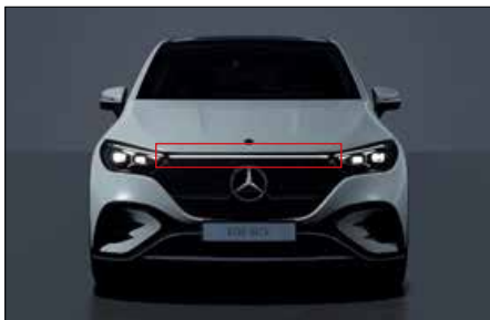
PAX+324 多光束智慧型數位頭燈含動態投影迎賓功能及極線式光條
